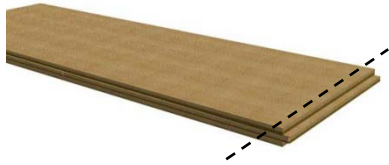
Figuur 2. Snij de tong eraf met behulp van een cirkelzaag
